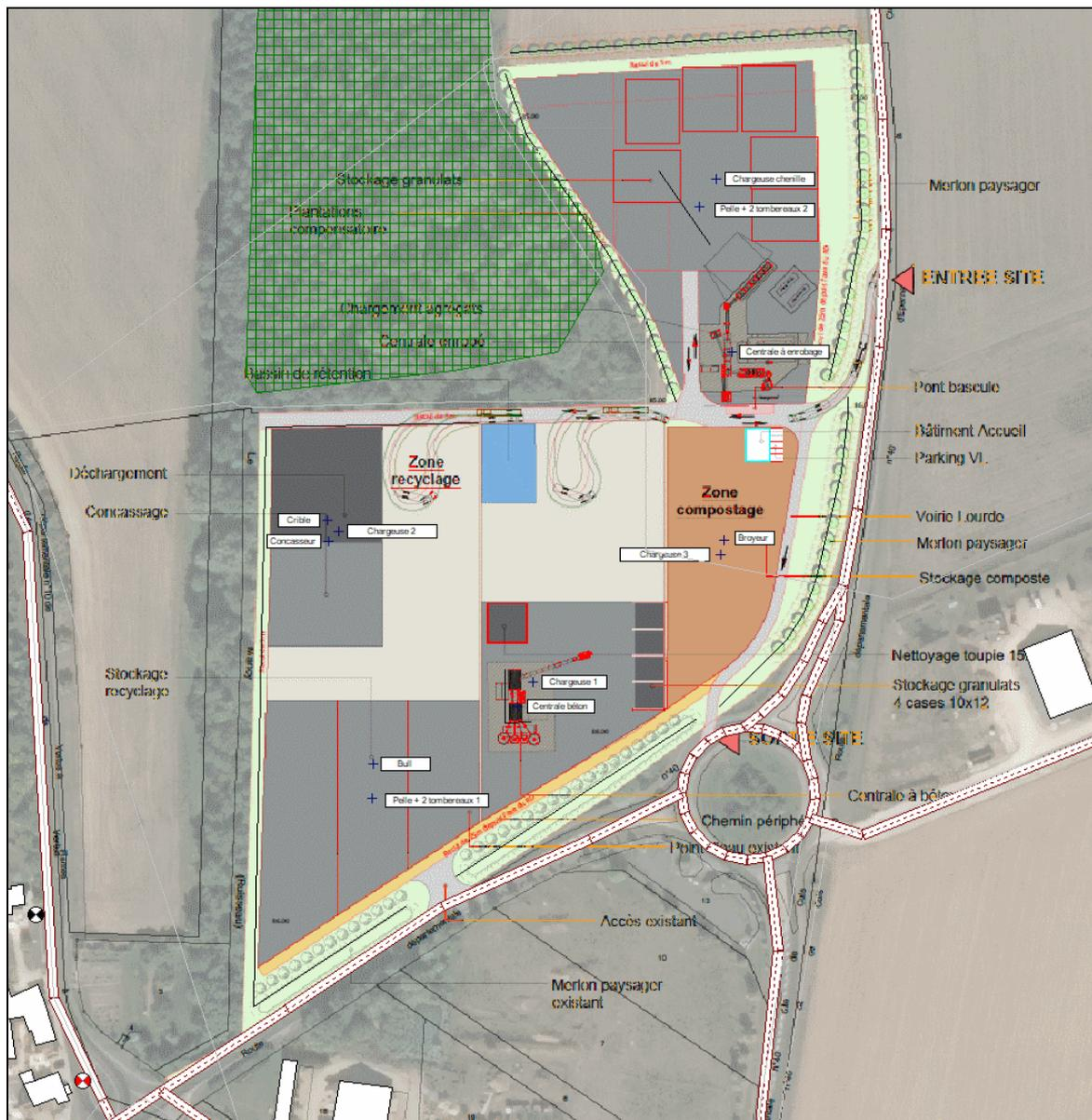
Figure 13 : Localisation des engins et équipements d'exploitation / fond de carte plan de faisabilité - 24/11/2021 implanté sous logiciel CadnaA
